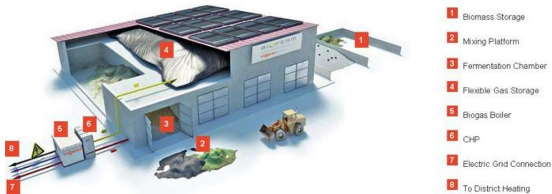
**Figure 3 : Représentation des principaux éléments d'une centrale en voie cuvée-sèche**
