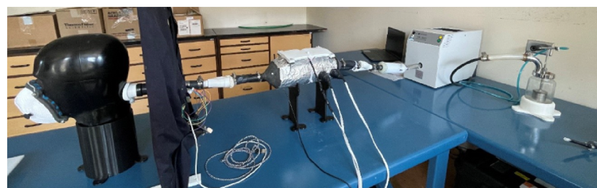
Figure 3 – Banc d'essai utilisé pour simuler la respiration humaine.
