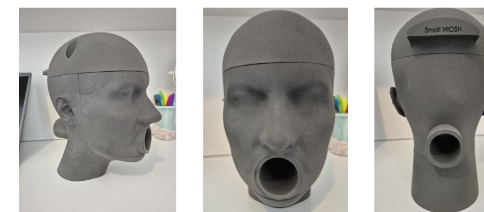
Figure 5 – Première tête de mannequin NIOSH imprimée en 3D avec la Fuse
