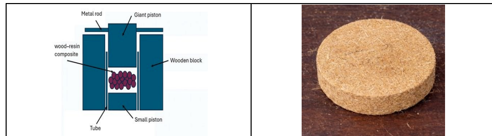
Figure 2 : Moule de fabrication et échantillon
